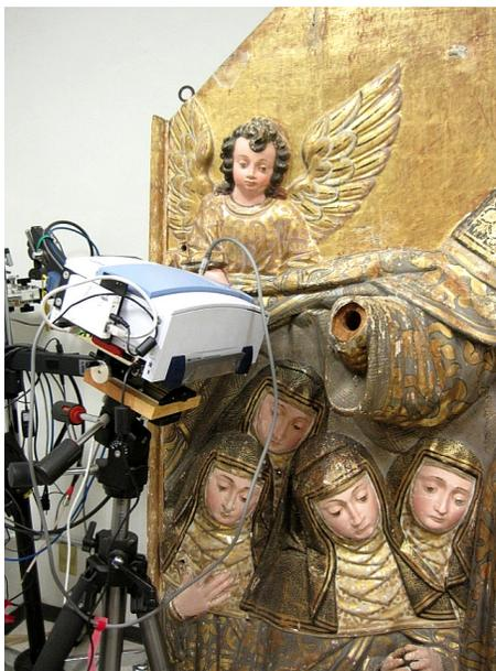
**Figura 6:** Estudio por espectroscopía infrarroja con transformada de Fourier (FTIR) con el equipo Alpha Bruker de un retablo colonial de Atlixco, Puebla. Coordinación Nacional de Conservación del Patrimonio Cultural, INAH.
