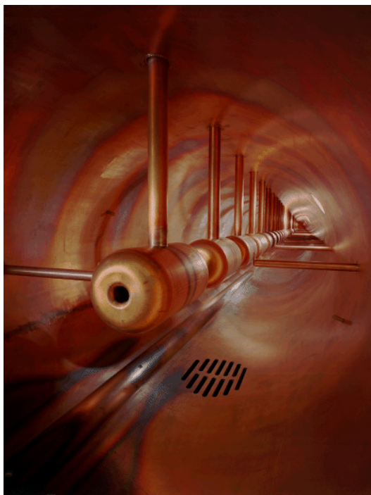
Figura 42.3: Algunos módulos de los tubos de deriva (drift tubes) en el acelerador lineal de Fermilab, el haz usual es de iones de hidrógeno negativo, H^- , en el diseño original era alimentado por un acelerador electrostático del tipo Cockroft-Walton.
